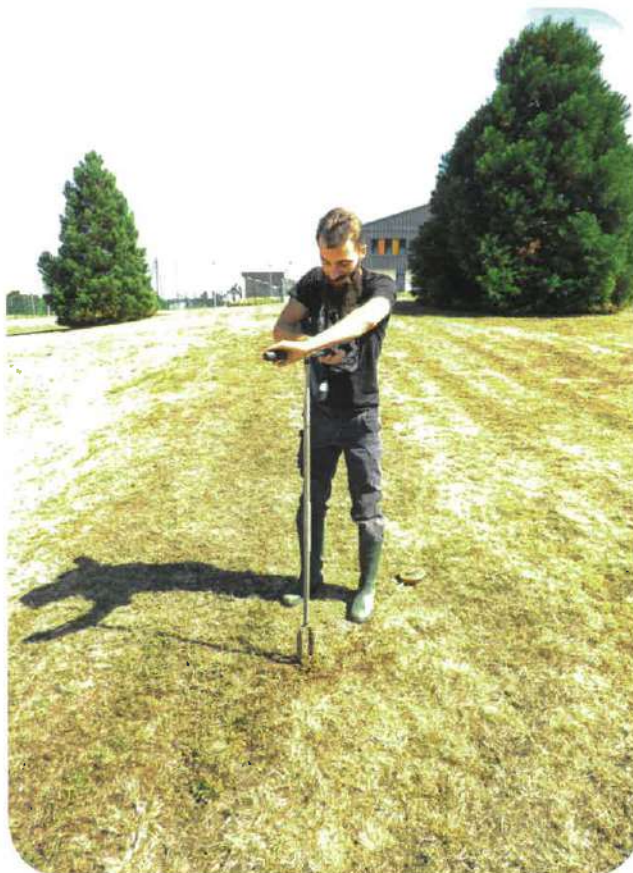
Carottage de terrain pour sonder la nature du sol
